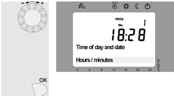
Abb. 9 Das Display zeigt die zu ändernden Stunden und Minuten an
